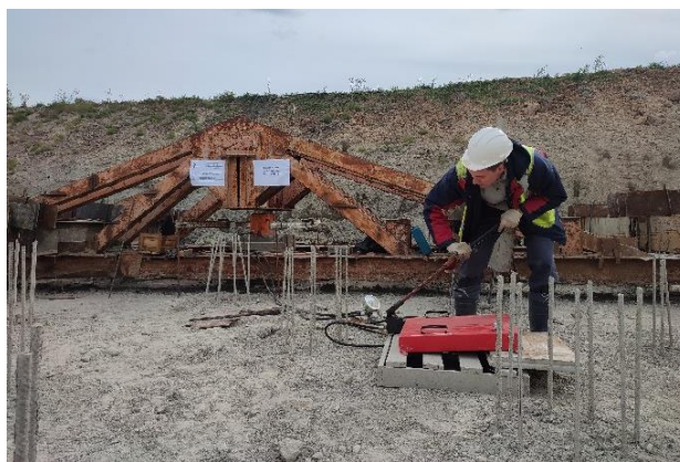
Рис. 3. Выполнение работ по устройству и испытанию опытных СПСу на площадке строительства цементного завода (респ. Мордовия)
